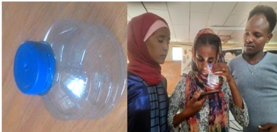
ሀ. ከአካባቢ ቁስ የተዘጋጀ ለ. ከአካባቢ ቁስ በተዘጋጀ ማይክሮስኮፕ ማይክሮስኮፕ በመጠቀም ናሙናን ማየት
